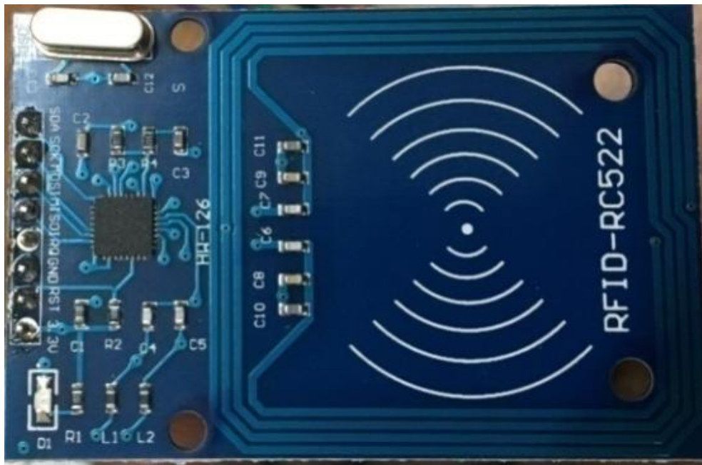
Fig. 3: RFID Reader Module (Detector)
